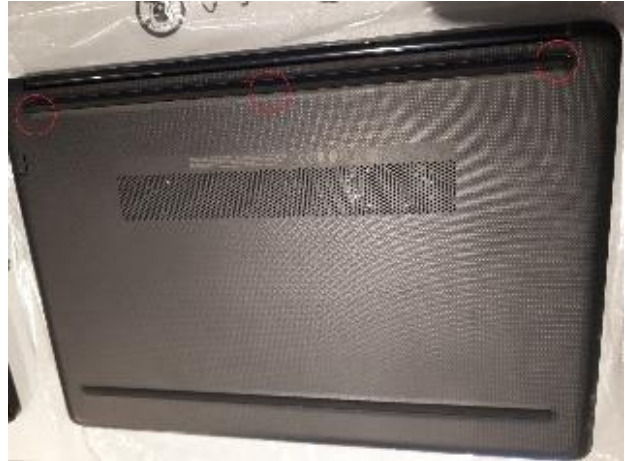
Démontage de la coque arrière.
